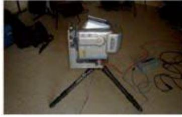
شكل (3-6) جهاز Laser Scanner الذي تم استخدامه في رفع الجامع الكبير. (موسى، 2010م)
